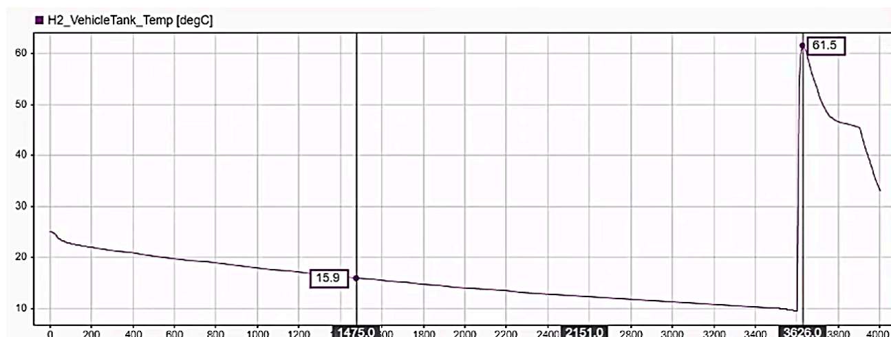
4. ábra. A jármű üzemanyagtartályának hőmérséklete a tankolás során
