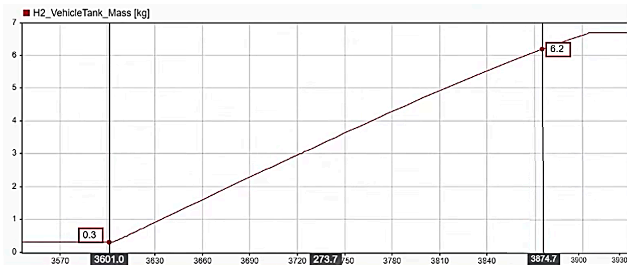
5. ábra. A jármű tartályába töltött hidrogén tömege
