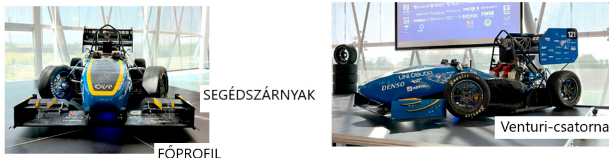
2. ábra. A versenyautó aerodinamikai elemei
