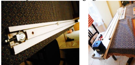
2. ábra. Bordás ékszíjas mozgatómechanika
