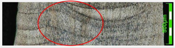
5. ábra. Korábbi hibás mintán, elcsúszott rétegek
