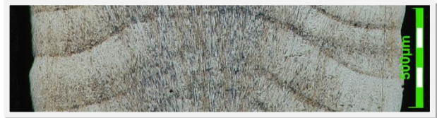
6. ábra. Megfelelő, réteg elhelyezkedés a jó mintán
