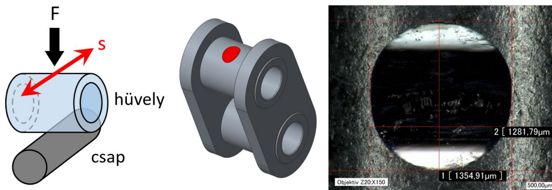
1. ábra. A tribométerbe szerelt csap-hüvely összeállítás élvi ábrája (balra), a hüvelyen keletkezett kopás szemléltetése (középen) és a kopásnyom digitális mikroszkópos felvétele az átmérők méretével (jobbra)
