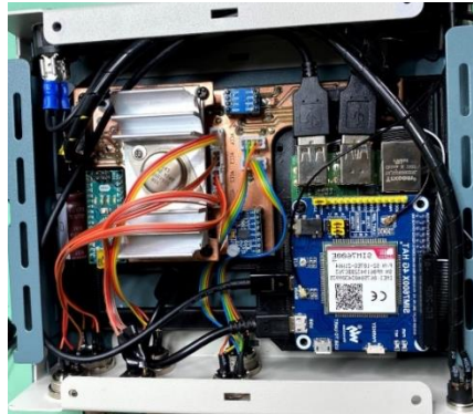
2. ábra Az elkészült útminőségmérő eszköz vezérlőegysége
