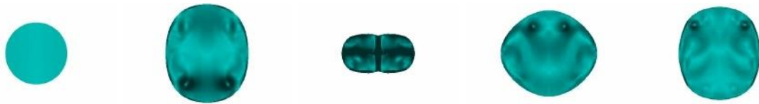
3. ábra. A második felületi módus szimulációja, ahol R_E = 20 \mu\text{m} , p_A = 0.5 \text{ bar} és f = 105.2 \text{ kHz}
