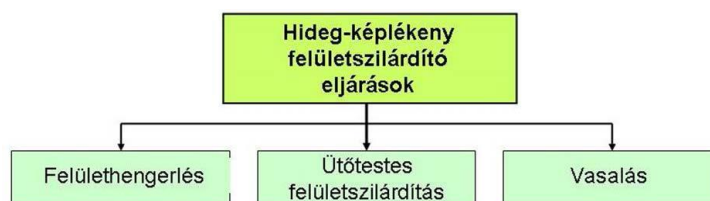
1. ábra. Hideg-képlékeny felületszilárdító eljárások eljáráscsoportosítása [1]
