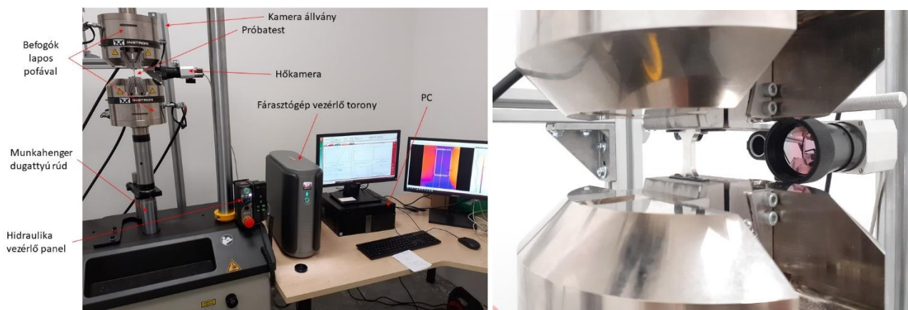
2. ábra. A validációs fárasztóvizsgálatokhoz használt mérési elrendezés
