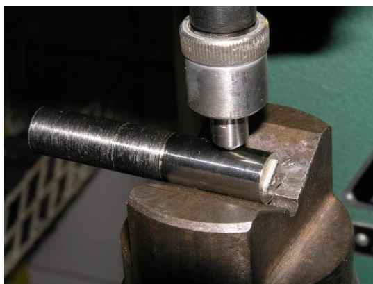
2.ábra: HV10 mérése prizmában palástfelületen
