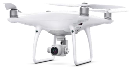
1. ábra. Forgó rotorral rendelkező drónok legelterjedtebb kivitele – Quadkopter [6]
