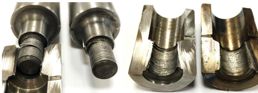
12. ábra. Szakítóvizsgálat utáni elnyíródott menetfelületek
