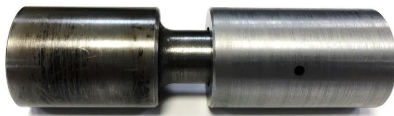
9. ábra. Szakítóvizsgálatra kész próbatest
