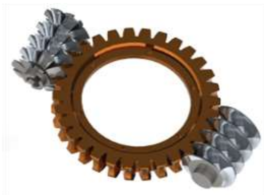
3. ábra. A tengelymetszetben körív profilú csigahajtás lefejtőmaróval [9]
