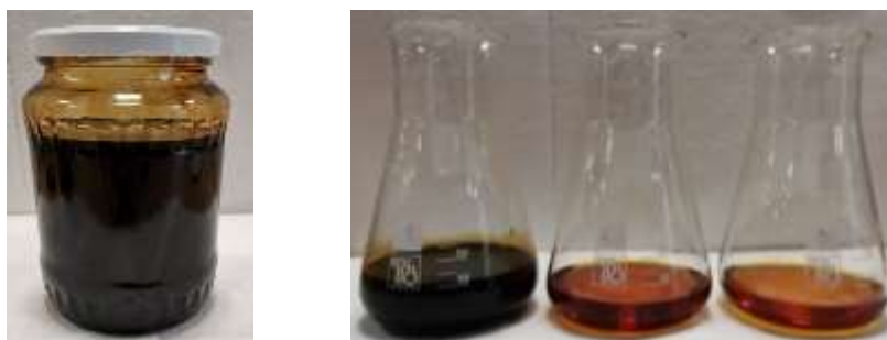
3. ábra Kiindulási elegy (bal); jobboldalt sorban: fenéktermék, első desztillátum frakció, második desztillátum frakció
