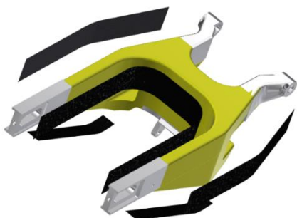
3. ábra. Az UD rétegek elhelyezése a kiforgácsolt habra
