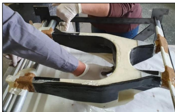
3. ábra. Az UD rétegek elhelyezése a kiforgácsolt habra
