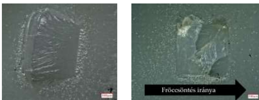
2. ábra Anyag kilágyulás okozta törés a 2x2 mm-es, négyzetes 10 cm 3 /s-os minta esetén (bal oldalt) és nyíróerő okozta törés a 40 cm 3 /s sebességnél, 2x2 mm-es négyzetes mintánál (jobb oldalt) (Keyence VHX-5000 típusú optikai mikroszkóp segítségével)
