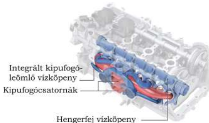
3. ábra Hengerfejbe integrált kipufogóleömlő az AUDI EA888 motoron [7.]
