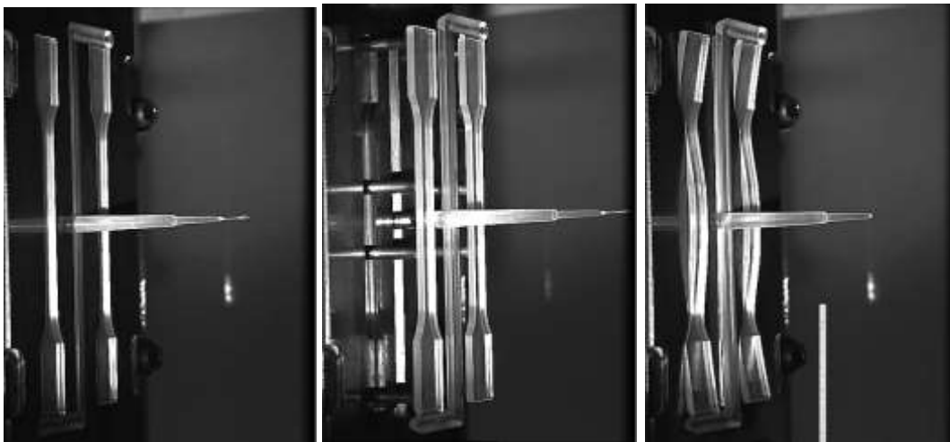
3. ábra Egyes kidobási folyamatok jellemző pillanatképei: ép termék a szerszámban (balra), ép termék és problémamentes kidobás (középen), kidobás folyamán megakadó/befeszülő termék (jobbra)
