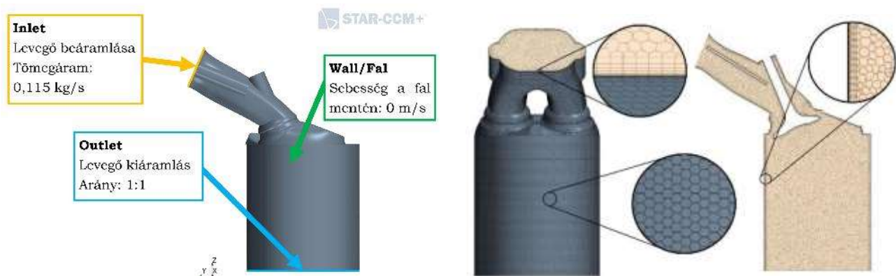
1. ábra. A számításos tartomány, a peremfeltételek, valamint a térfogati háló és metszete
