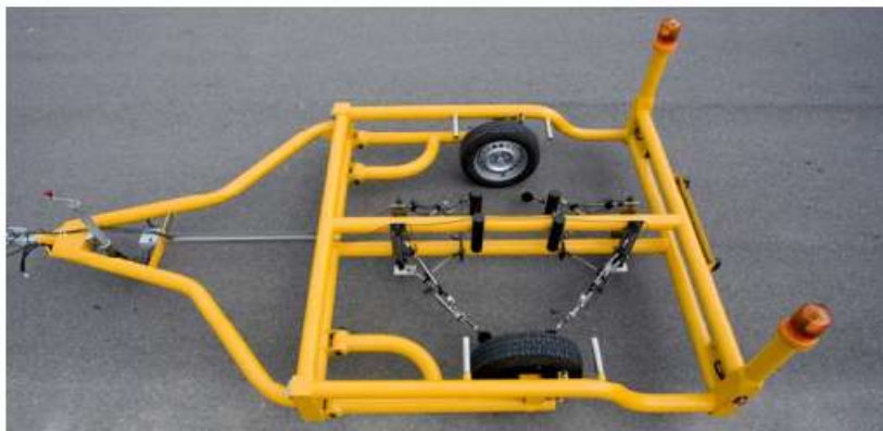
5. ábra: CPX mérő pótkocsi kialakítása [4]
