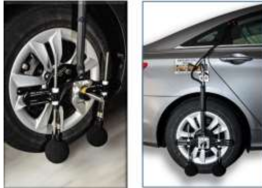
6. ábra: OBSI rendszer a gépjárműre szerelve [1]
