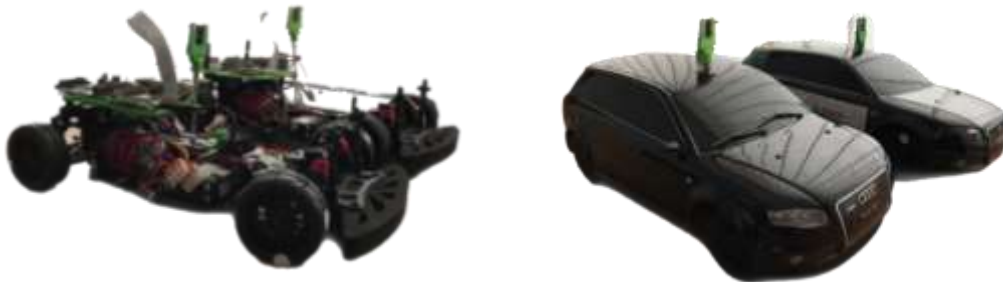
2. ábra Járműmodell platform karosszéria, futómű és elektronikus komponensek
