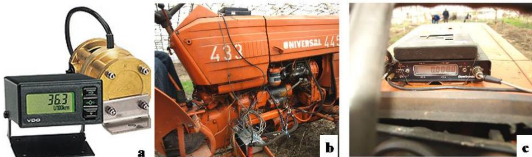
3. ábra Tüzelőanyag fogyasztás mérése: a – EDM 1404 tüzelőanyag fogyasztást mérő berendezés, b – mérőberendezés helye, c – kijelző [3]
