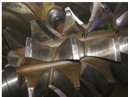
5. ábra A maró-fog H homloklfelületének lábhenger pontjaira illesztett L és vágóél pontjaira illesztett V Bézier görbe
