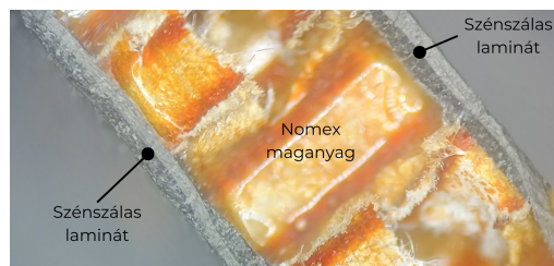
1. ábra. A szendvicsszerkezet metszete
