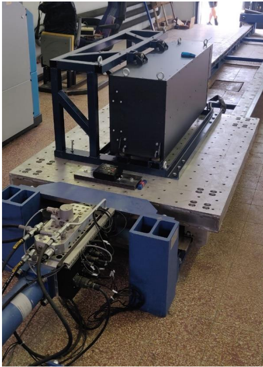
2. ábra: Az akkumulátor az ütköztető padon.
