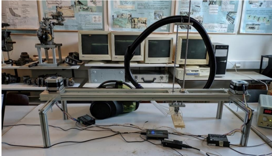
7.ábra Összeszerelt vetőrobot
