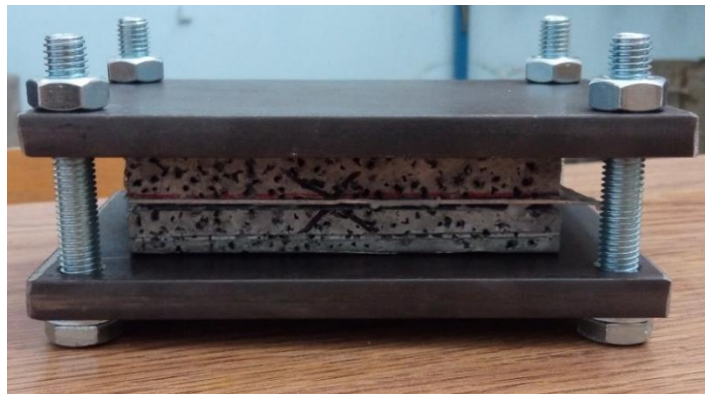
1. ábra. Forrasztási elrendezés fotója
