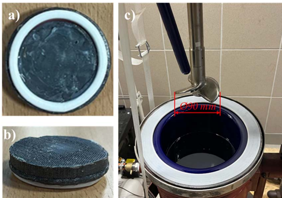
2. ábra. Az additív gyártással készült tantálfolt (felületcsiszolás előtt) a) felülnézetben és b) oldalnézetben, valamint c) a reaktor (nyitott állapotban) és a keverésre használt propellerkeverő
