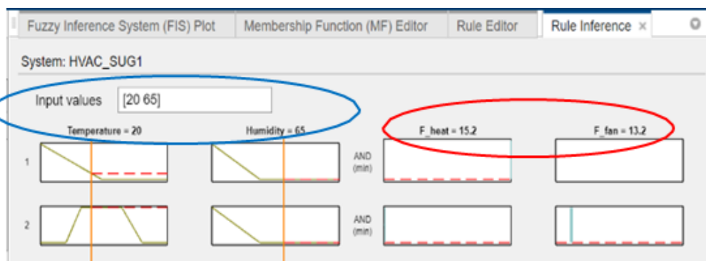
4. ábra. A FuzzyLogicController 'rule inference' ablak részlete a bemeneti változók és a beavatkozó jelek pillanatnyi értékeivel
