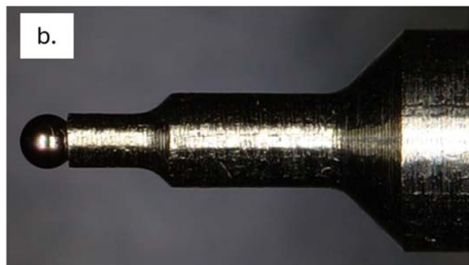
2. ábra. A négyzet próbatest fogadására alkalmas a.) matrica aktív szerszámeleme; b.) golyó végződésű bélyeg
