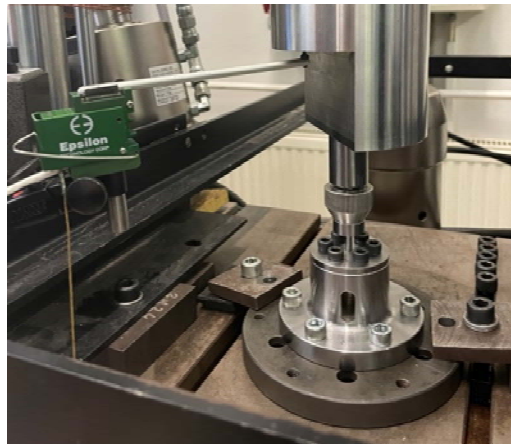
4. ábra. A mini SPT vizsgálati elrendezés elmozdulás méréssel
