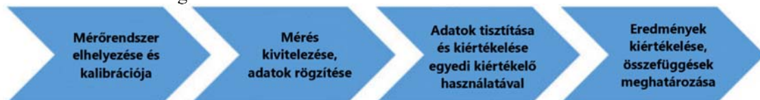
1. ábra: Mérési módszer ciklus-diagramja, közelítésérzékelő szenzor használata esetén
