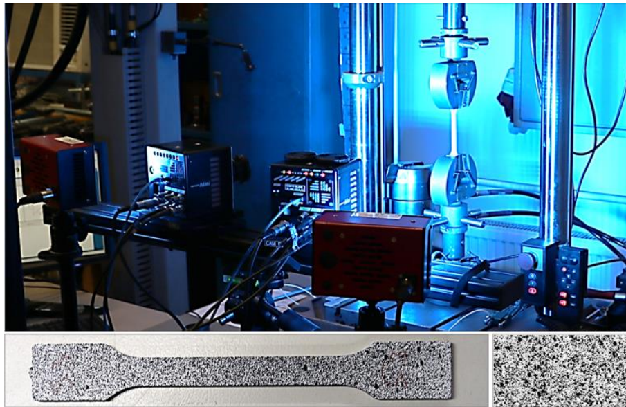
1. ábra. Optikai nyúlásméréssel végzett vizsgálat elrendezése (fent), a próbatestre felvitt egyedi mintázat és annak nagyítása (lent).
