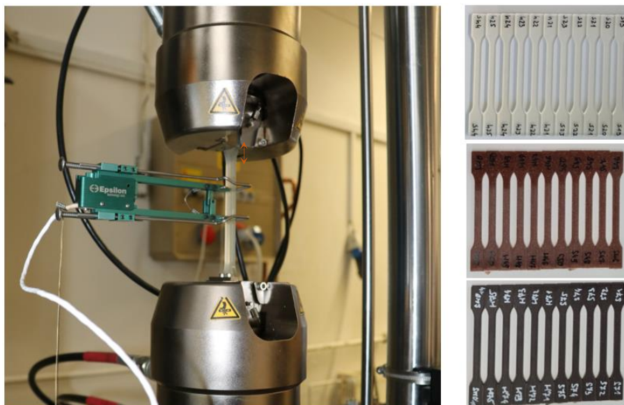
2. ábra. Extenzométeres nyúlásméréssel végzett vizsgálat elrendezése (bal oldalt) és a PLA alapú különböző anyagösszetételű szakítópróbatestek (jobb oldalt).
