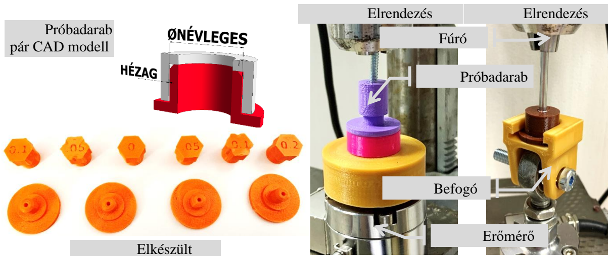
1. ábra. Csatlakozó méretek irányelv modellkísérlet elemei; bal oldalt: próbadarab párok CAD modellje egy elkészült sorozattal; jobb oldalt: a mérési elrendezés összenyomásra és széthúzásra
