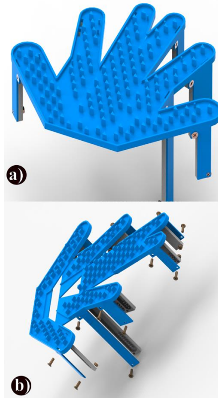
3. ábra Szilikon öntőforma modellje a) összeállított, b) robbantott ábra formájában
