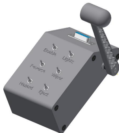
4. ábra A kapcsolótábla 3D nyomtatott háza, kézigázkarral szerelve
