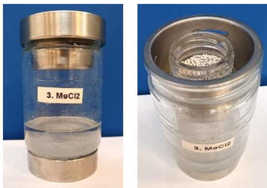
4. ábra. Az oldattartó üveg összeszerelt állapotban, illetve csavarzár nélküli
