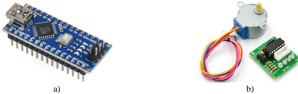
7. ábra. Fő alkotóelemek: a) Arduino Nano vezérlő; b) léptetőmotor (5v)
