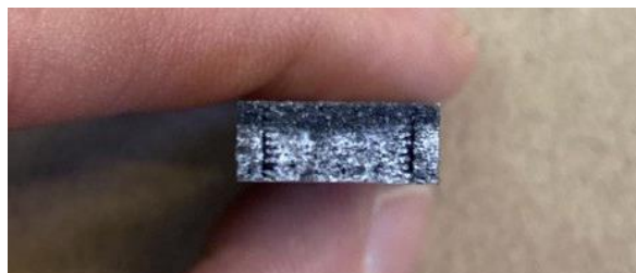
5. ábra A CF10 minta törési felülete
