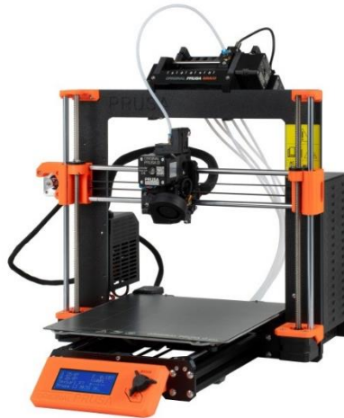
1. ábra Original Prusa I3 MK3S+ nyomtató az MMU3 egységgel [4]
