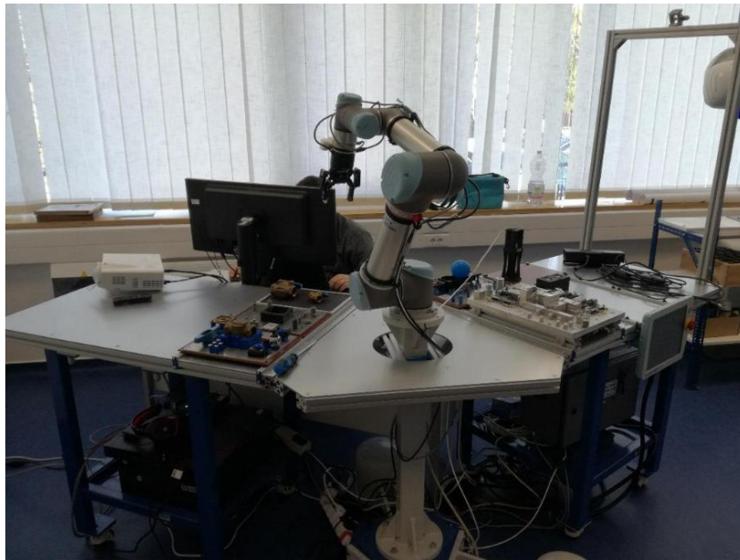
1. ábra Kollaboratív robotos szerelő munkaállomás
