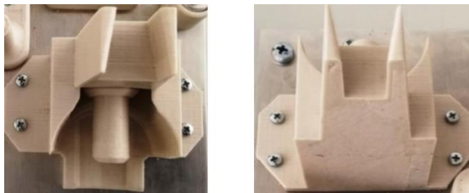
4. ábra Gömbcsap csavarozását támogató házfixáló passzív tartóelem
