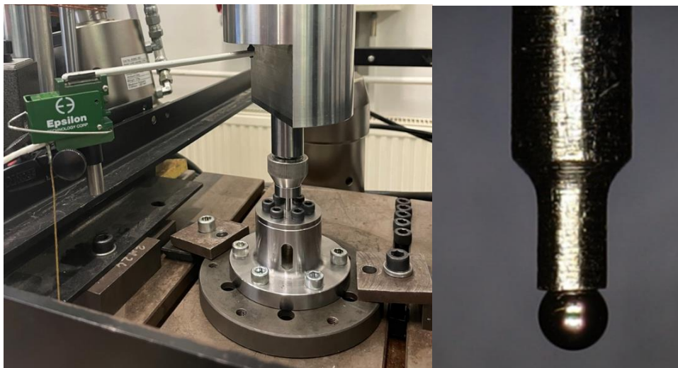
4. ábra. Az SP vizsgálat laboratóriumi összeállítása
