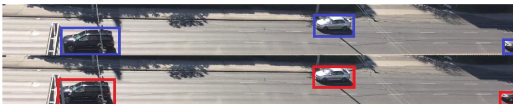
13. ábra. Detektált járművek két egymást követő képkockán
