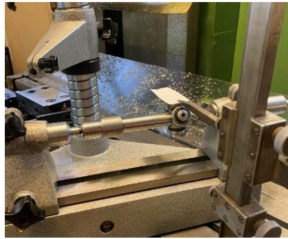
4. ábra Féltengelycsillag mérése talpas karctűvel
