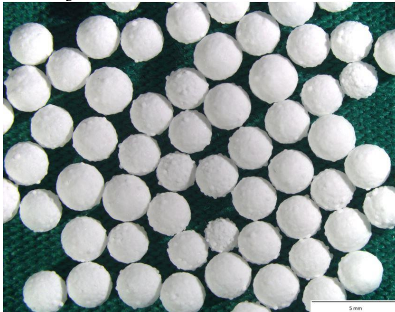
1. ábra A gyártás során használt kerámia gömbhéjak
