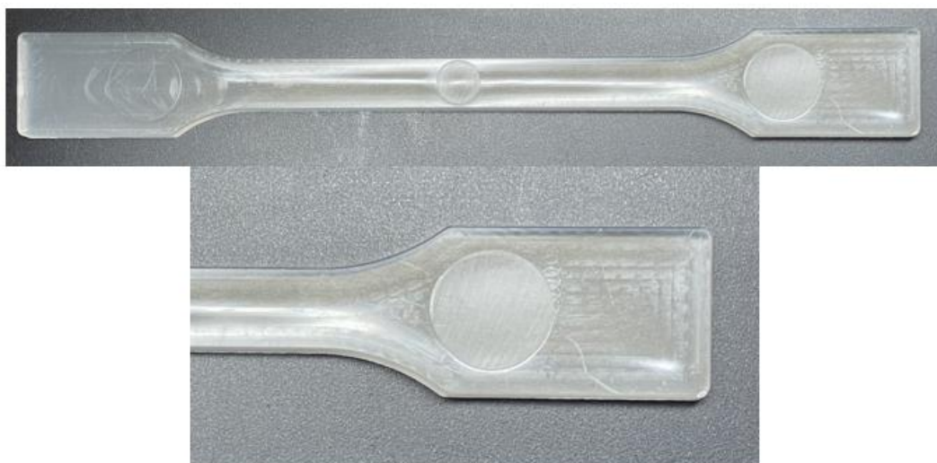
4. ábra: Fröccsöntött próbatestek felületi hibái
