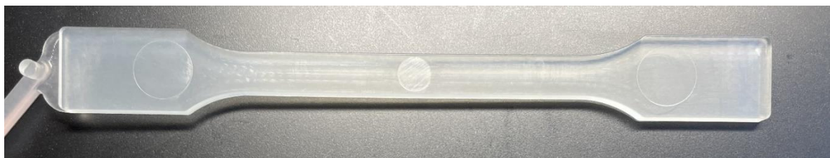
8. ábra: Hibamentesen fröccsöntött próbatest
