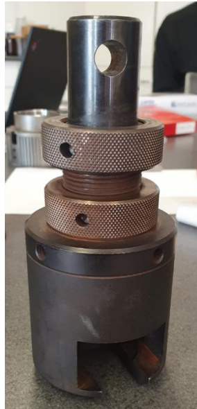
10. ábra. Szakítógép befogó készüléke
