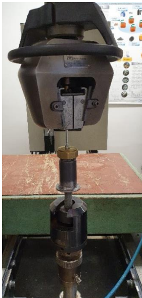
9. ábra. 2020 Bosch profil szakítás közben
