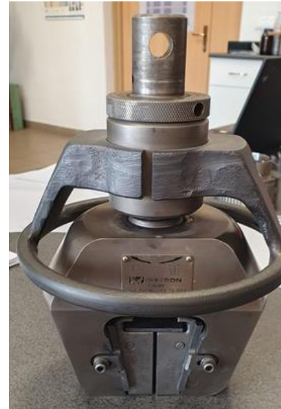
11. ábra. Szakítógép befogó készüléke
