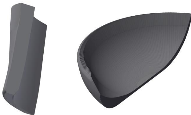
2. ábra Forgóborona és talajmaró egy-egy pengéje által „kivágott” talajforgács
