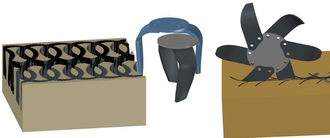
1. ábra Merevtest kivonásos módszer használatával, forgóboronával és talajmaróval megtömlesztett talajrészek
