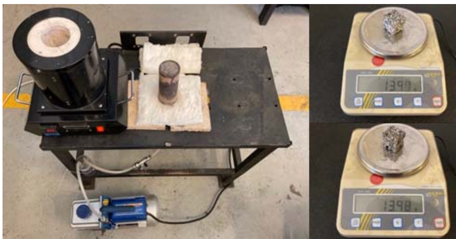
2. ábra A perlites habkészítés berendezése és kész habminták
