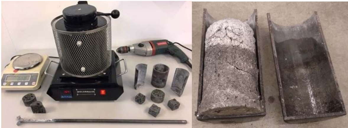
1. ábra A habosításhoz használt eszközök és a kész zártcellás aluhab.
