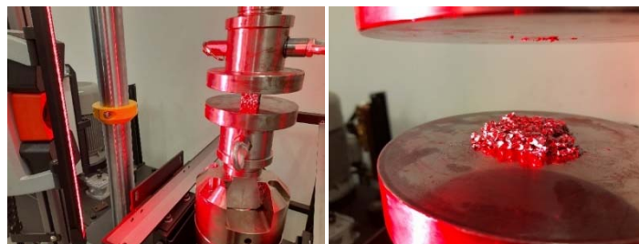
4. ábra Próbatest a fásztóvizsgálat kezdetén és a vizsgálat befejezése után
