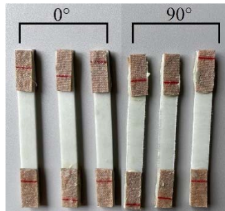
2. ábra. A széliránynak megfelelő ( 0^\circ ) és arra merőleges ( 90^\circ ) szakítópróbatestek
