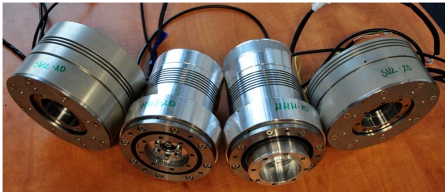
2. ábra. Kísérleti hengeres- és síkkerekes hullámhajtásrendszerek
