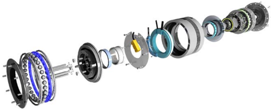
3. ábra. A kísérleti sikkerekes hullámhajtómű robbantott ábrája
